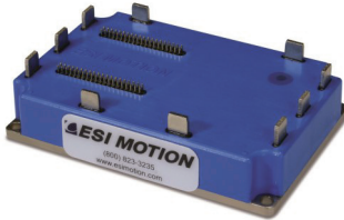
Dual-axis Mite 2.0”L x 3.0”W x 0.6” H
